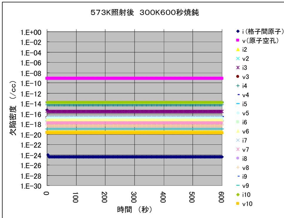
焼鈍による欠陥密度変動や照射温度の影響を定量的に計算・比較する事ができます。
