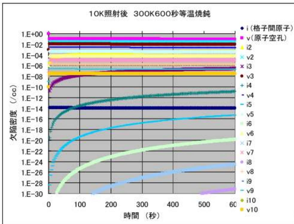
固体内の欠陥の 熱処理による集合体形成過程を計算することができます。
