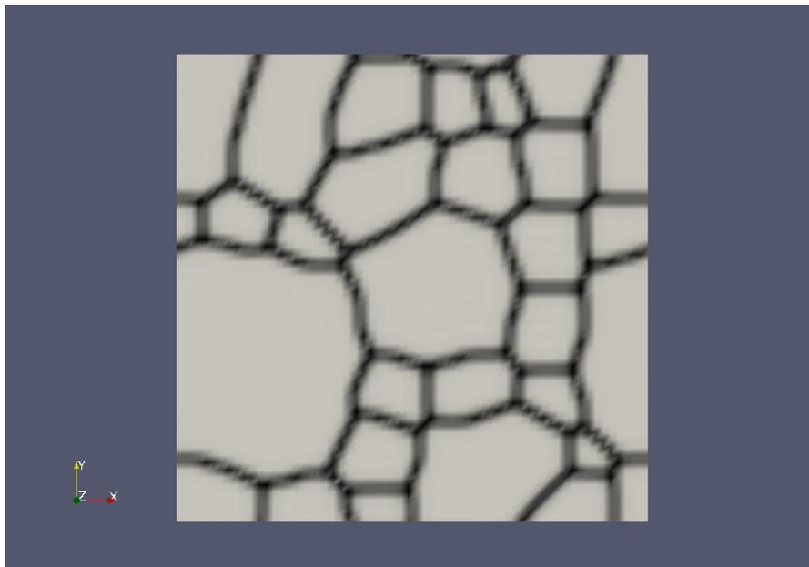
この一つ一つの結晶粒に結晶軸の向きを 3 次元的<sup>8</sup>にランダムに割り当てることで多結晶状態を表現する。
