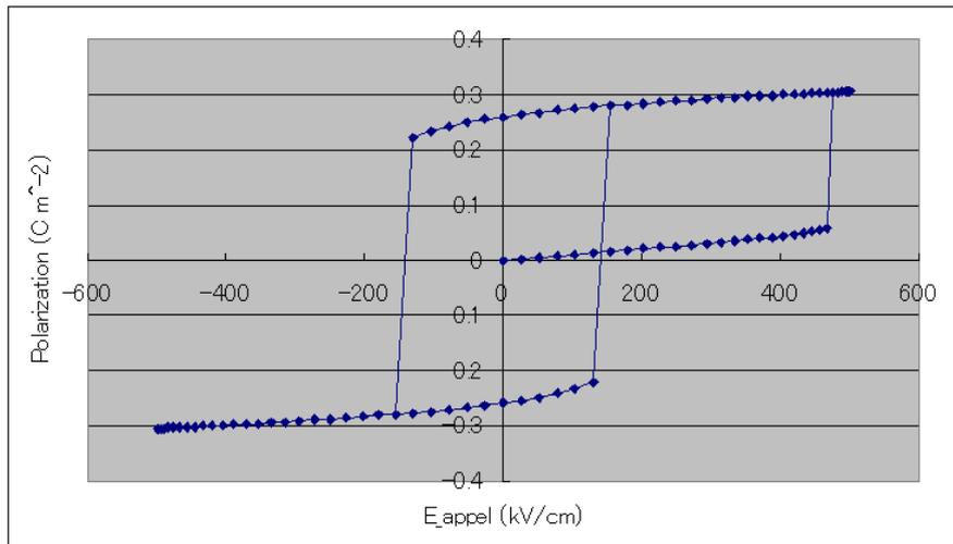
4.1.1 節の場合よりも転移する印加電場の大きさがやや大きい。これは、欠陥による双極子場が存在するため、より強い電場を加えなければ分極ベクトルの向きを変えることができないためであろう。またループの中心はシフトしていないが、これは印加電場の向きと欠陥による場の向きが直交しており、印加電場を後押し/妨害しないからだと考えられる。
