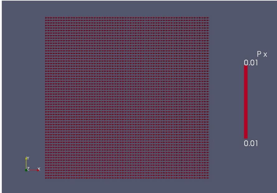
この図は、下図のように拡大すると分かるように錐が配置されている。錐の向きは分極ベクトルの向きに、色は分極の大きさに対応している。
