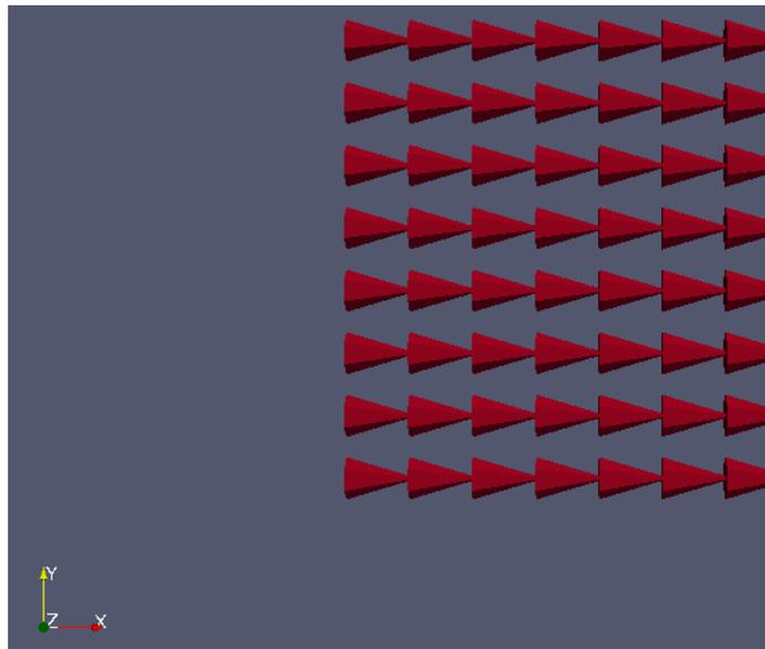
この状態で計算を開始すると印加電場がゼロであっても、全ての分極ベクトルが  $x$  軸の正の方向に向いた状態が安定な状態となる。これは、欠陥数密度が至る所でゼロである点を除けば、論文 [1] III C 節の状況に等しいと言える。
