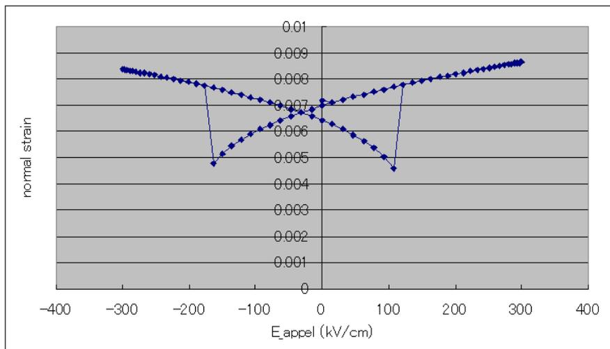
両者とモループが印加電場の大きさの軸の負のほうへシフトしている。これは欠陥が存在することにより生じる分極および双極子場が印加電場を「支え」ているためである。（今のモデルでは、欠陥による双極子場の向きは印加電場がゼロのときの分極ベクトルの向きであるとしている。そし
