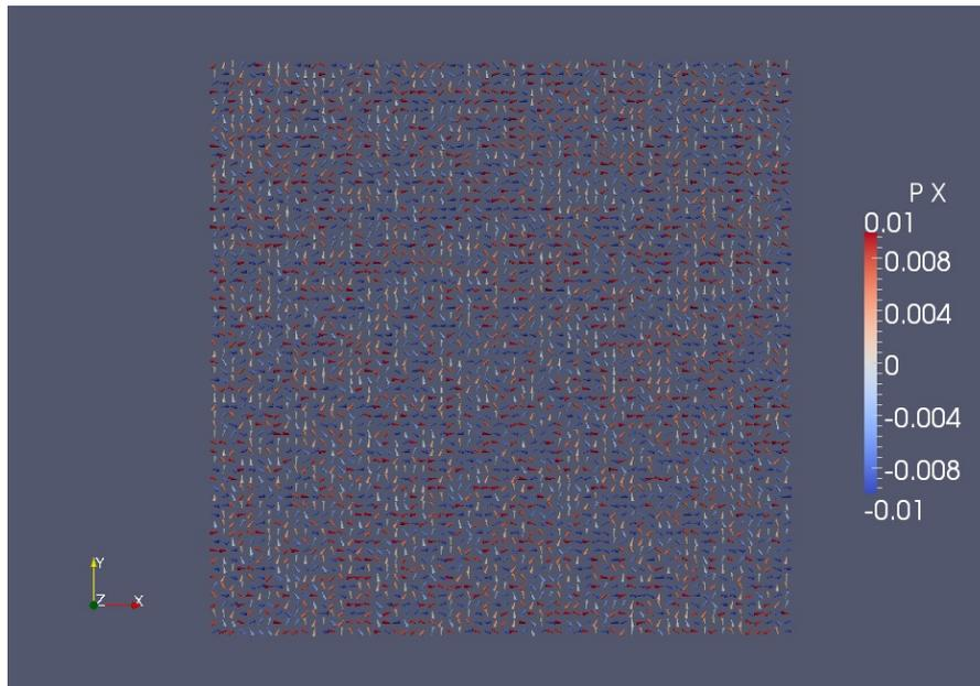
この状態からまず印加電場の大きさが  $0 \text{ kV/cm}$  のときの安定状態を計算する。安定状態での分極ベクトル場の様子は下図の通り。初期状態でランダムな方向を向けておいた状態から、このような構造を持つ状態が自然と生成される。
