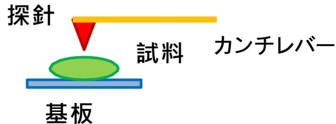
探針・試料間に働くファンデルワールス力(原子間力)の大きさによって、カンチレバーはバネのように曲がる
