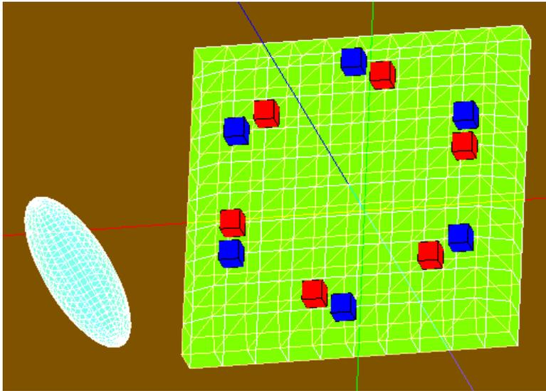
探針:幅2[nm]、深さ2[nm]、高さ10[nm]の回転楕円体
