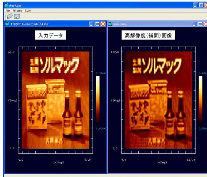
•FFTを利用した高解像度化。パラメータを変化させることで任意の倍率で高解像度画像を作成。
